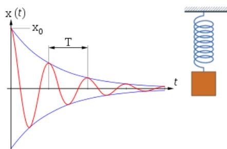
Abb. 4a: Darstellung einer gedämpften Schwingung (wikipedia 2012).
